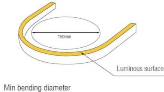
Biegen Sie das Profil nur in die angegebene Richtung. Bei Nichtbeachtung der angegebenen Hinweise wird die elektrische Funktionalität des Produkts beeinträchtigt. Verdrehen Sie den IP Flex nicht.
