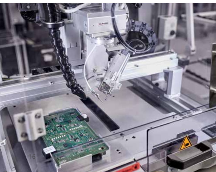
ELMOTEC Tischlötroboter SolderSmart® TOP mit Zwei-Schubladen-System im Einsatz ELMOTEC table-top soldering robot SolderSmart® TOP with two-drawer system in use
