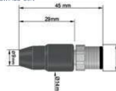
Maßzeichnung New Motor Connector „SNM“
